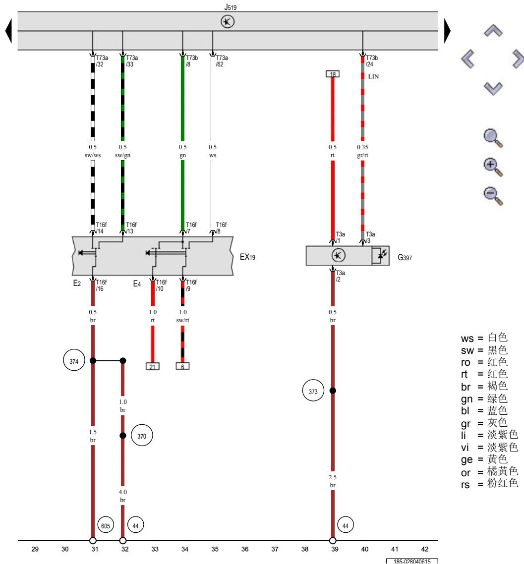
转向信号灯开关, 手动防眩目功能和远光灯瞬时接通功能开关, 左侧转向柱开关, 雨水与光线识别传感器, 车载电网控制单元
