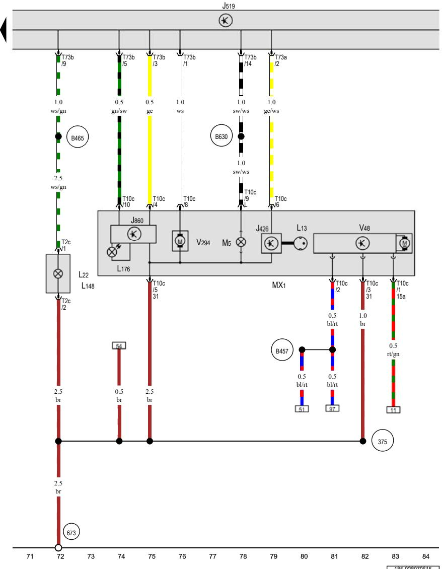
左侧气体放电大灯预接装置, 车载电网控制单元, 左侧白天行车灯和驻车示宽灯控制单元, 左侧气体放电灯泡, 左侧前雾灯灯泡, 左侧弯道灯灯泡, 日行车灯和驻车灯左侧光电管模块, 左前大灯, 左前转向信号灯灯泡, 左侧大灯照明距离调节伺服电机, 左近光灯防眩目
