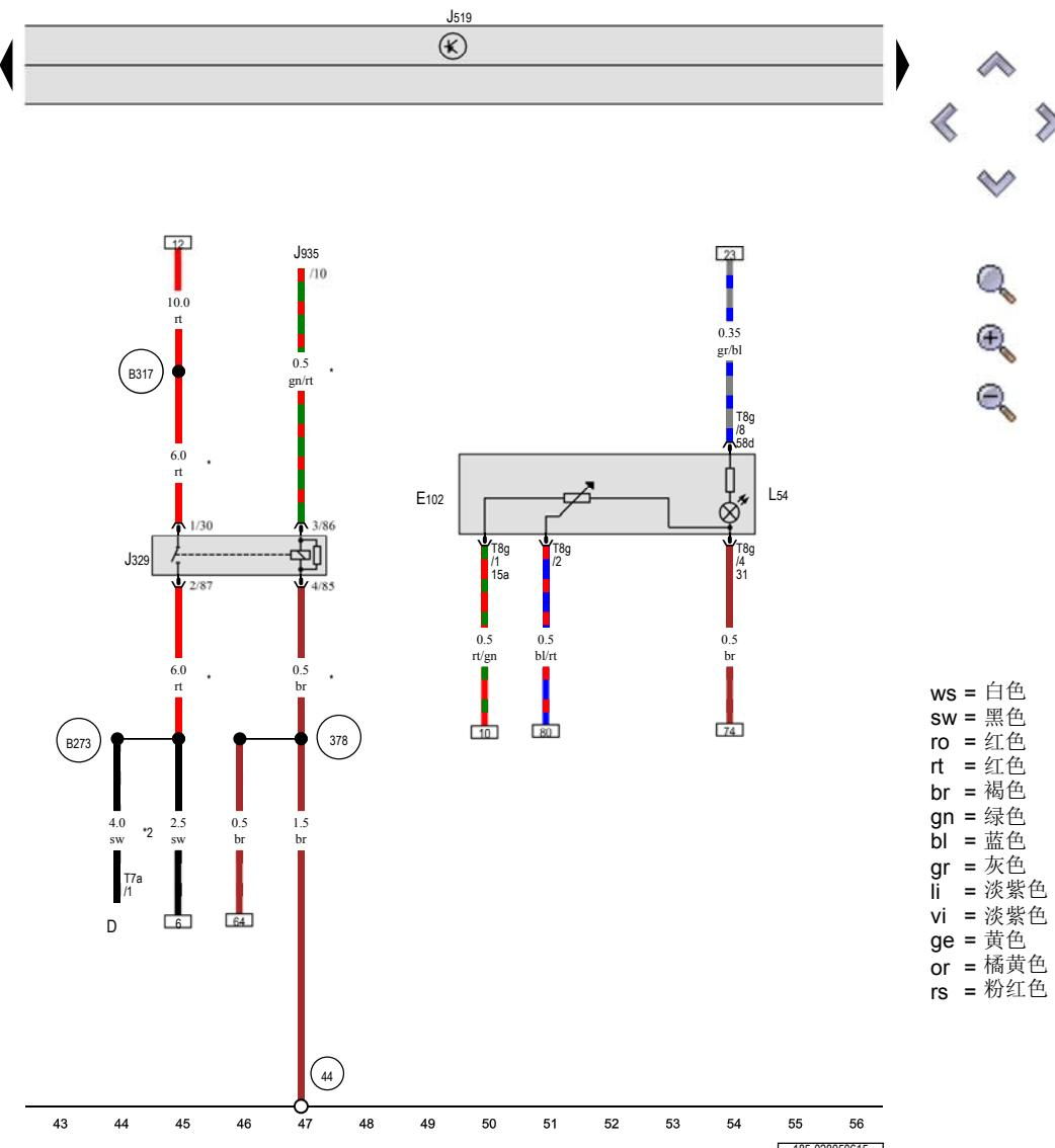
大灯照明距离调节器, 端子 15 供电继电器, 车载电网控制单元, 大灯照明距离调节设置器照明灯泡
