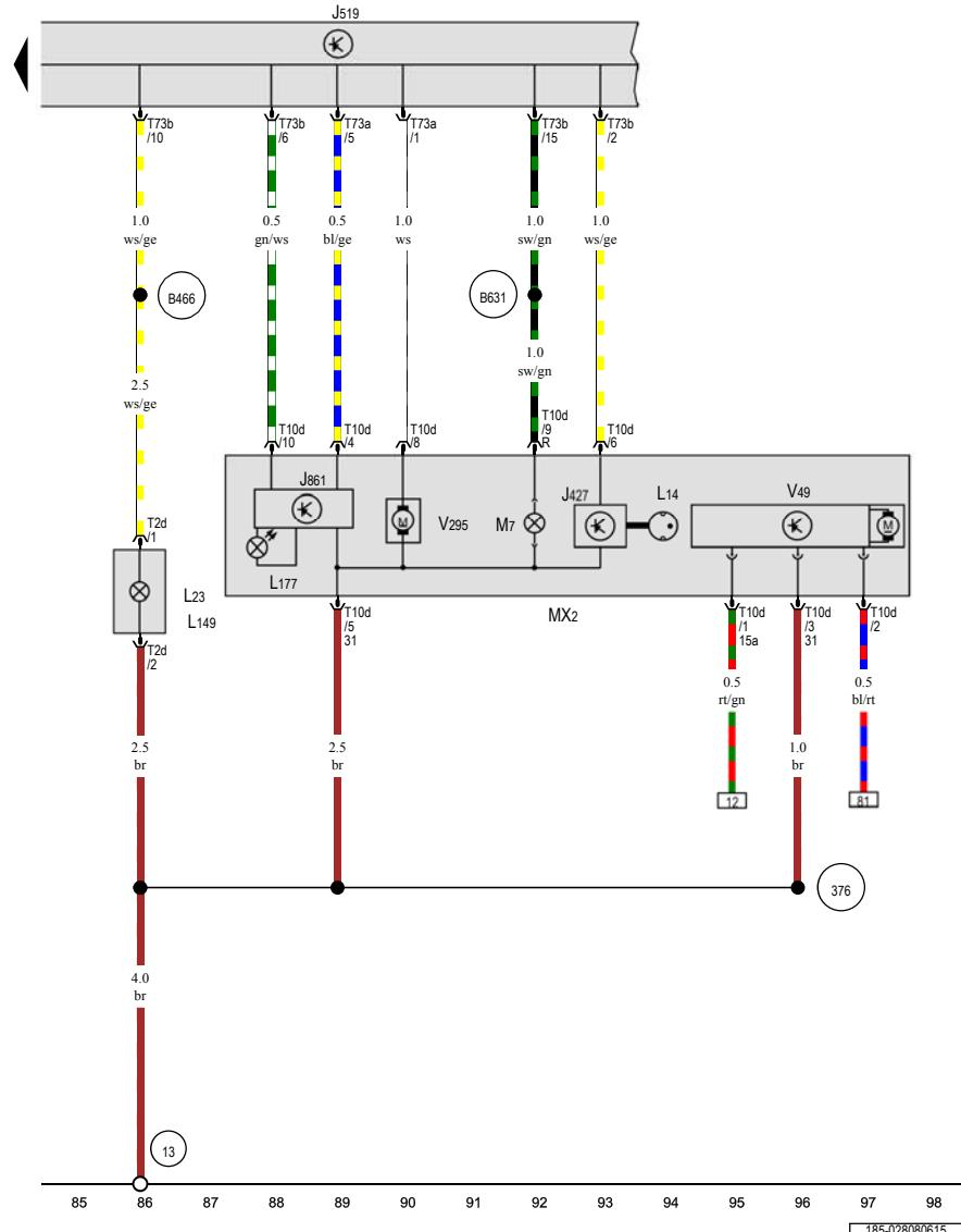
右侧气体放电大灯预接装置, 车载电网控制单元, 右侧白天行车灯和驻车示宽灯控制单元, 右侧气体放电灯泡, 右侧前雾灯灯泡, 右侧弯道灯灯泡, 日行车灯和驻车灯右侧光电管模块, 右前大灯, 右前转向信号灯灯泡, 右侧大灯照明距离调节伺服电机, 右近光灯防眩目遮蔽
